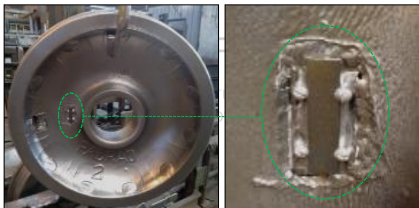
Figura 6A) Localização da tira Almen C no disco dianteiro
